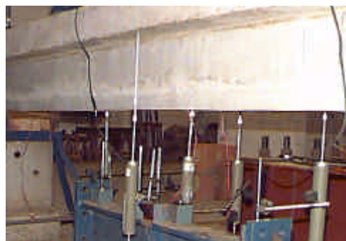
(b) posição dos transdutores para o meio do vão e a 1/3 do vão
