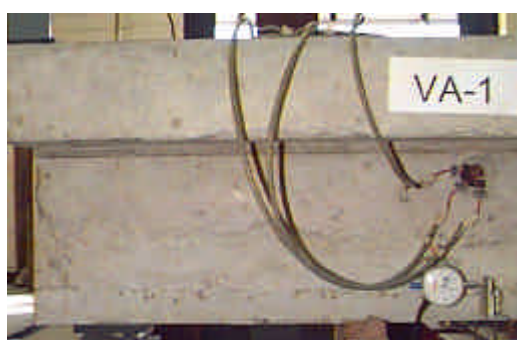
(a) relógio comparador a 50 cm do apoio e roseta no concreto
