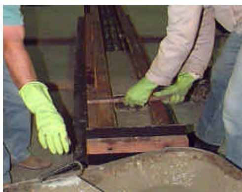
(a) moldagem da viga VA-1
